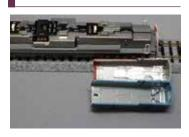
カトー製DD51は製品によってボンネット内のプリズムの長さが異なります.
